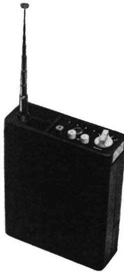
Bild 12.2 Empfänger für den Europäischen Funkrufdienst
